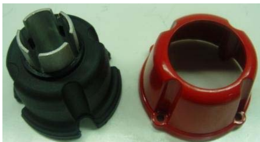
Amortiguador central monoblock armado y desarmado
