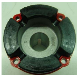
Amortiguador central monoblock armado y desarmado
