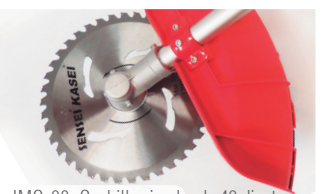
IMG-08: Cuchilla circular de 40 dientes.
