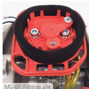
IMG-02: Filtro de aire.
